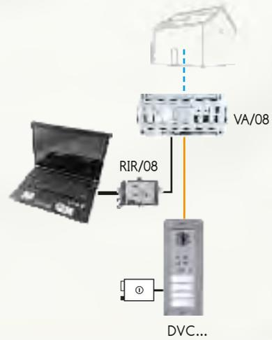
... il est possible de réaliser le contrôle des accès par programmation manuelle pour de petites installations résidentielles.
