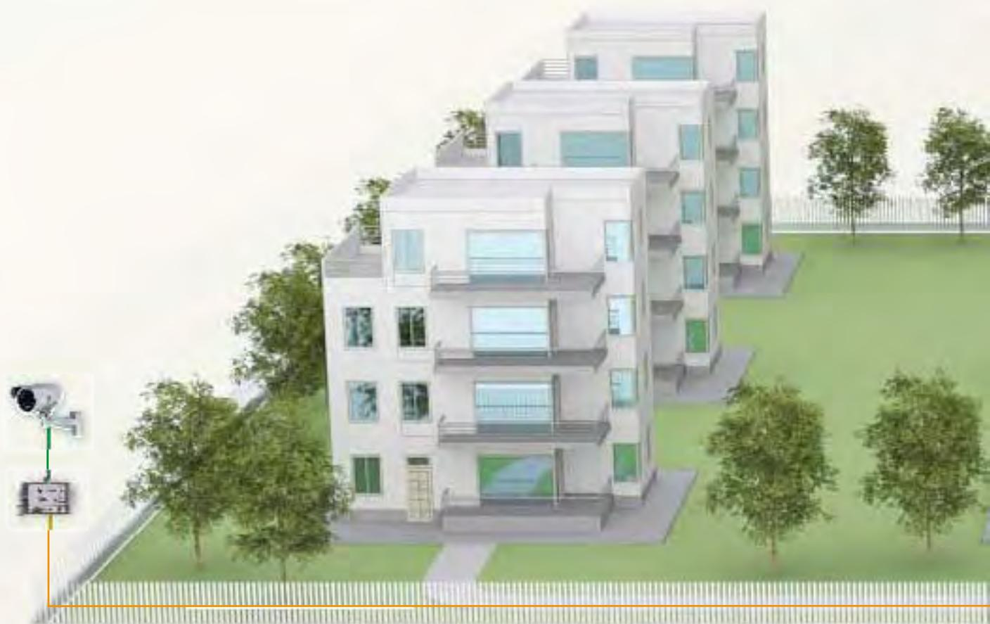
Il est possible de réaliser des installations de complexes résidentiels d'une grandeur moyenne en utilisant le réseau de connexion entre entrée/s principale/s et simples bâtiments résidentiels (habitations et/ou petits immeubles) à l'aide d'une simple paire torsadée non polarisée (pour des performances optimales il est possible d'utiliser le câble dédié BPT type VCM/ID).
